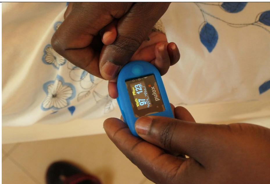
Bild 14 Neues Pulsoximeter für Erwachsene (schwere Herzinsuffizienz)
