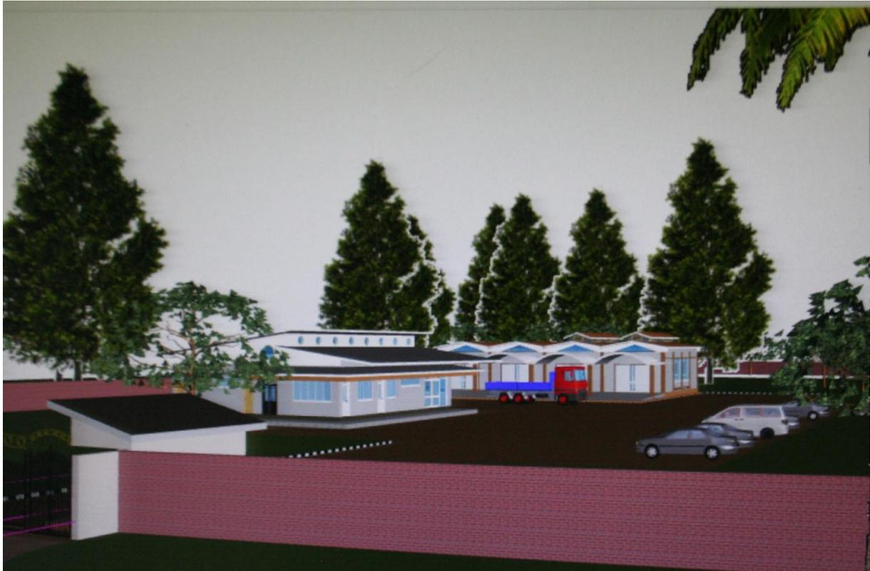
3-D-Modell des Lager- und Distributionszentrums in Birinzi mit einem Verwaltungs-/Verarbeitungsgebäude, Lagergebäude mit zwei Kühl- und zwei Trockenlagerräumen, Schutzmauern, Wasserversorgung mit Wasseraufbereitung, Energieversorgung und Reserveflächen für einen späteren bedarfsgerechten Ausbau mit weiteren Einrichtungen, Wohnräumen, Garage etc.
